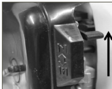
Рис. 9 Рычаг управления воздушной заслонкой
